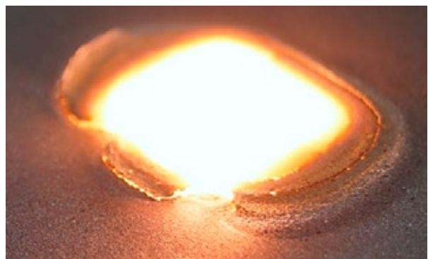
Mit Präzision für lange Lebensdauer: Die Laser-Tape-Technologie kann auch kleinste Schäden an Bauteilen passgenau reparieren. Die tatsächliche Größe dieses Tapes beträgt 10 mal 10 Millimeter.
