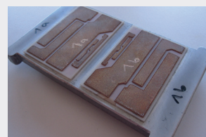
Elektronik Part AlN auf Al-Platte
